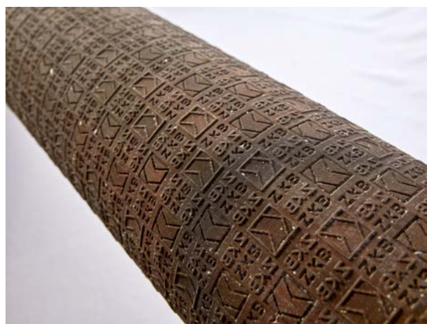
Logo von 1981 auf einer Egoutteurwalze, die zur Herstellung von Papier mit Wasserzeichen verwendet wurde. [5]
