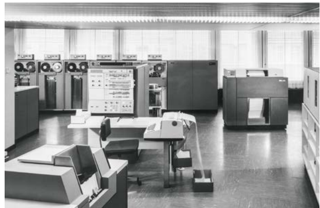
Die ersten Datenverarbeitungsanlagen belegten ganze Räume. Hier gezeigt: Lochkartenstanz- und Leseeinheit, Bedienpult, Schnelldrucker und Magnetbändereinheiten von 1970. [4]
