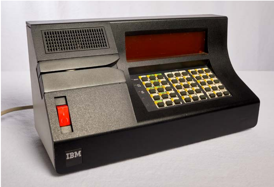
BUSY-Terminal mit Kartenschlitz (links), Tastatur (rechts unten) und Anzeige (rechts oben). [3]
