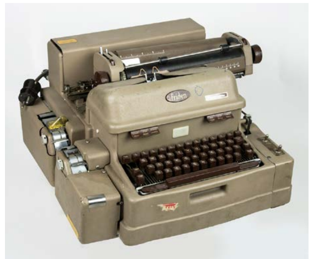
Eine Friden Flexowriter, wie sie bei der Zürcher Kantonalbank im Einsatz stand. Links ist die Lochstreifen-Vorrichtung für automatisiertes Schreiben deutlich sichtbar. [3]
