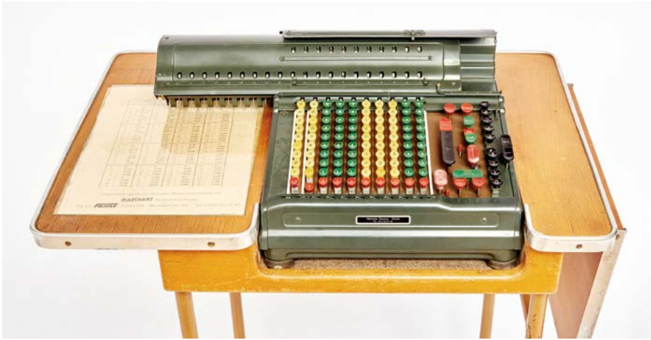
Elektrische Rechenmaschine Marchant, um 1950. Sie konnte addieren und multiplizieren, arbeitete sehr schnell und verursachte nur wenig Lärm.
