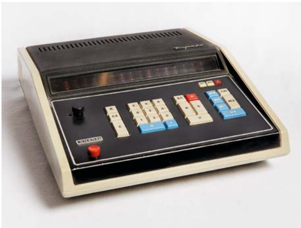
Elektronische Rechenmaschine Sharp Compet 32, in Japan hergestellt, um 1960. Nun eroberte die Elektronik die Büros der Zürcher Kantonalbank, zunächst in Form kleiner Tischrechner.
