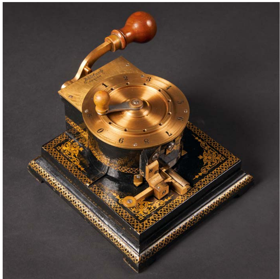
Als die Checknummern noch aus kleinen gestanzten Löchlein bestanden, kam dieser Checkperforator zum Einsatz.
