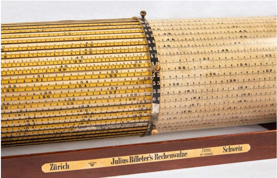
Diese Rechenrolle ermöglichte das Ablesen logarithmischer Tabellen und wurde zur Zinsberechnung gebraucht.
