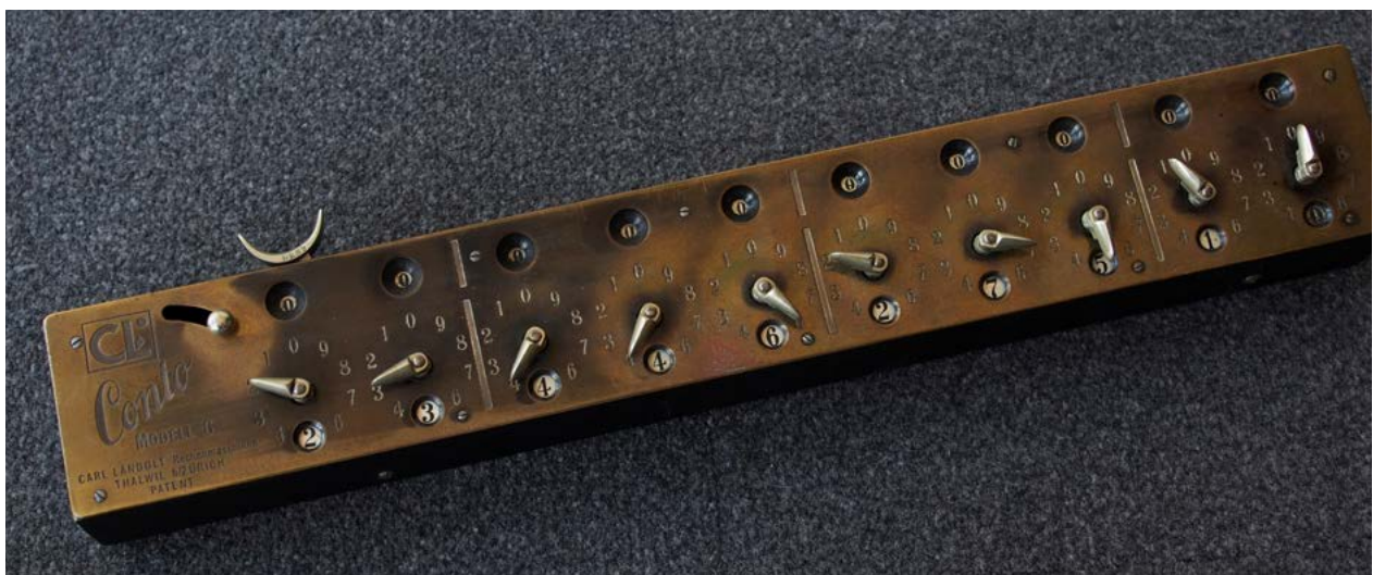
Addiermaschine Conto C von Carl Landolt, Thalwil, 1920er Jahre. Sie besitzt eine ungewöhnliche Eingabe über Drehanzeiger. [5]
